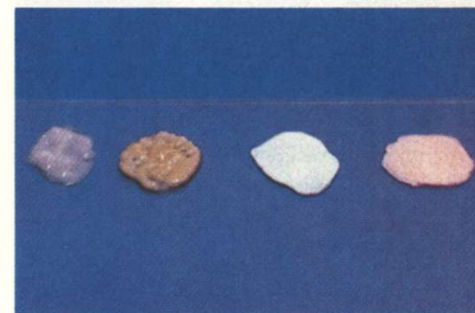
6. Erikoisnesteellä kostutetut massat, vasemmalla esipoltettu massa, oikealla tavanomaisen massa
