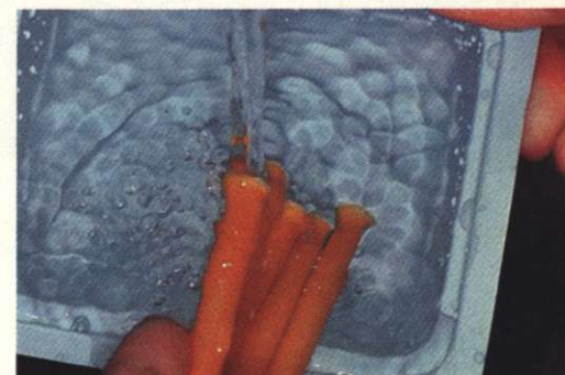
14. Laminaatit kastetaan happoon ja huuhdotaan kylmässä vedessä.
