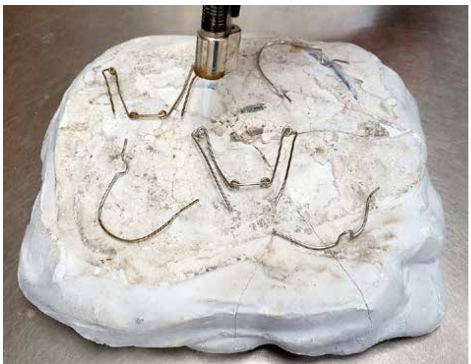
"Lämpökäsittelyn voi tehdä, joko liekillä tai johtamalla virtaa langan läpi, jolloin lanka lämpenee (Kuva 4).
