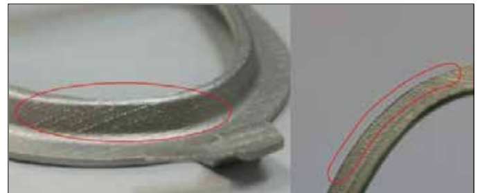
Kuvio 9. Joihinkin koerangoissa syntyi laserin sironnasta epätasaisuutta ja osaan terävistä reunoista tulostui pieni valli. Molemmat porattiin pois kovametalliterällä ennen sovistusta.
