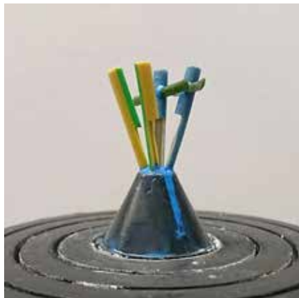
Kuva 2. Sähkökaapelin suojaputkesta valmistetut burn out-valuaihiot
