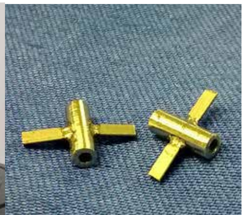
Kuva 3. CoCo:sta valetut putket valmiina
