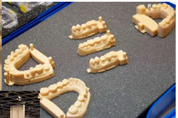
Printtaamalla valmistetut ”kipsimallit”.
