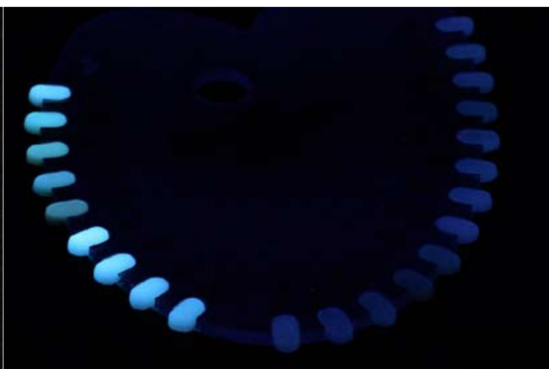
Kuva 3. Kiillettä imitoivat massat eivät fluoresoi.
