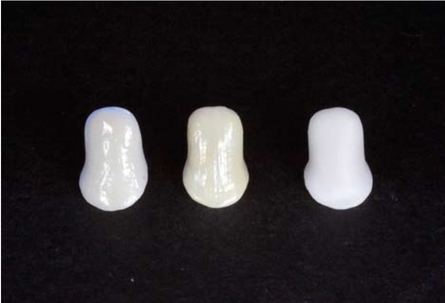
Kuva 17. Vasemmalla oleva zirkoniahetta käsitelty fluoresoivalla keramiaseoksella. Keskimmäinen keramiavalmistajan omalla zirkonialinerilla. Oikealla oleva käsittelemätön zirkoniahetta.
