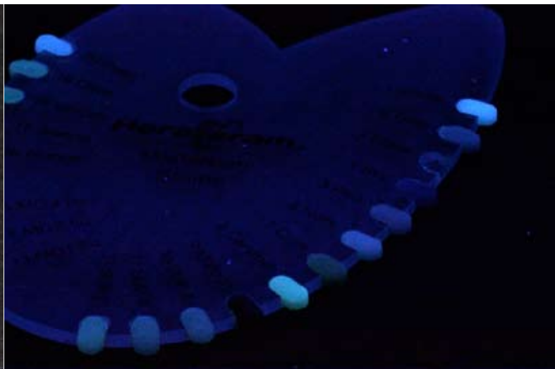
Kuva 9. Vain puhtaan valkoinen ja tarkoituksella fluoresoivaksi tehdyt maalivärit fluoresoivat.
