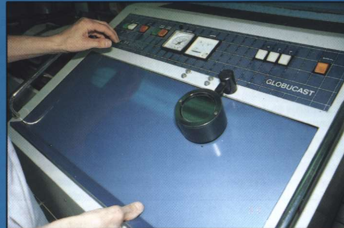
Kuva 16. Valulinko, joka sulattaa korkeajaksoperiaatteella
