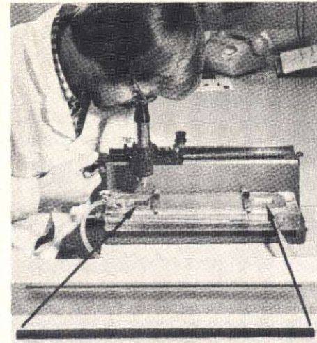
Kuva 3. Lineaarisen lämpölaajenemisen mittausta. Etualalla on koekappale ja sen valmistusmuotti, joka on kehitetty tätä koetta varten.
