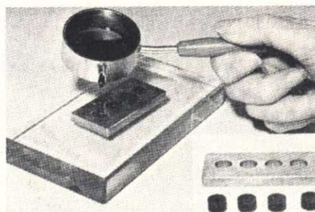
Kuva 1. Koekappaleiden valmistus muovautuvaisuuden ("flow") testausta varten.
