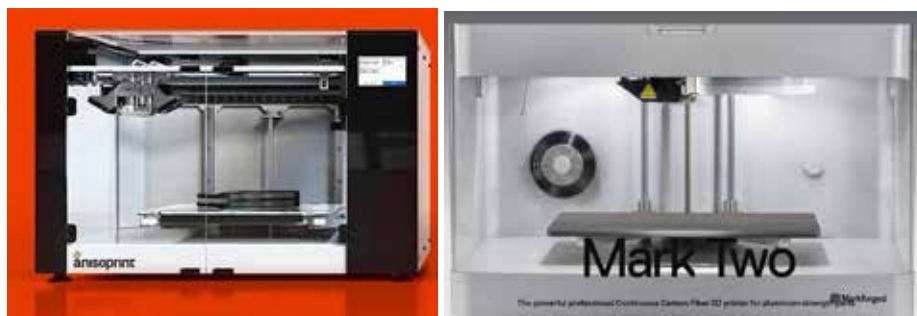
Kuva 1. Vasemmalla Anisoprint Composer A4 ja oikealla Markforged Mark Two ( https://markforged.com/ , https://anisoprint.com/ )
