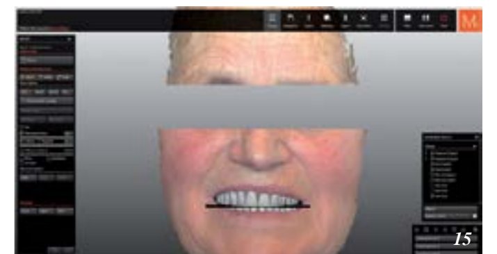
Projekti siirrettiin Zirkonzahn.Modifier ohjelmaan, mikä automaattisesti asemoi hampaat aikaisemmin skannaus ohjelmassa määritettyjen tasojen mukaisesti (Plaster Plane). Tämän jälkeen hammasteknikko pystyi tarkalleen asettelemaan hampaat kasvo skannausten mukaisesti ja merkkamaan ikenien ulkorajat myöhempää ien osien suunnittelua varten (kuvat 14 – 16).
