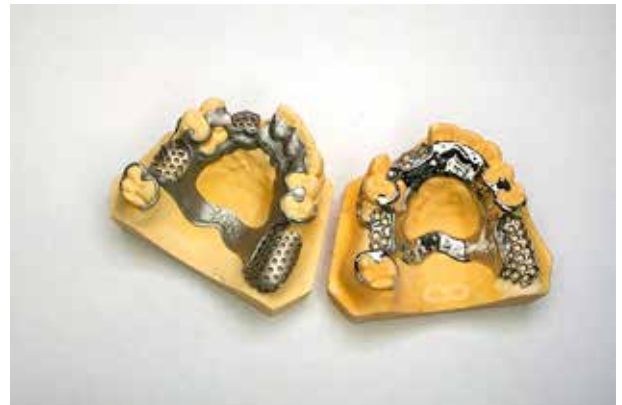
Kuvio 1. AM Finlandilta tullut lasersintrattu ranka (vas.) sekä valmis valettu ranka (oik.).
