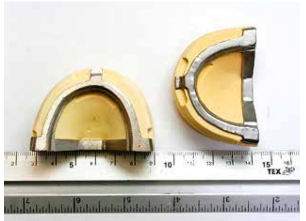
Kuvio 4. Istuvuuskappaleet, vasemmalla lasersintattu ja oikealla valettu.
