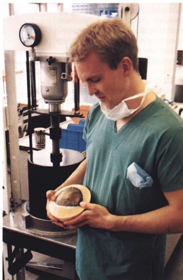
Titaanilevyjen muotoiluun käytettävä prässä
