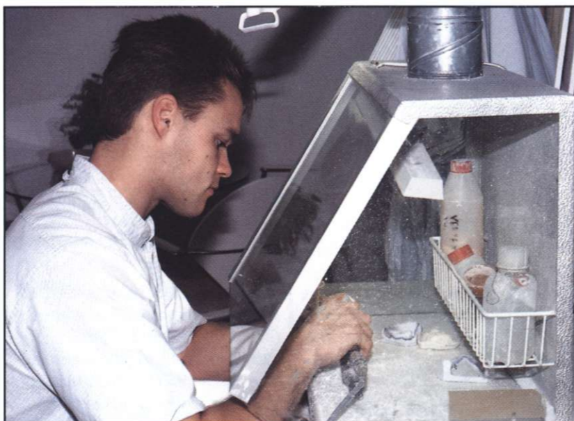
Hammasteknikko-oppilas Juha Nykänen freesaa imukaapissa. Huomaa kaappiin sjoitettu 18 W loistelamppu sekä teline akryylinesteille.
