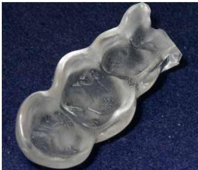
3D-tulostusmateriaali (merkki ei tiedossa) ollut yhteensä 16 tuntia 100% käsidesissä.
