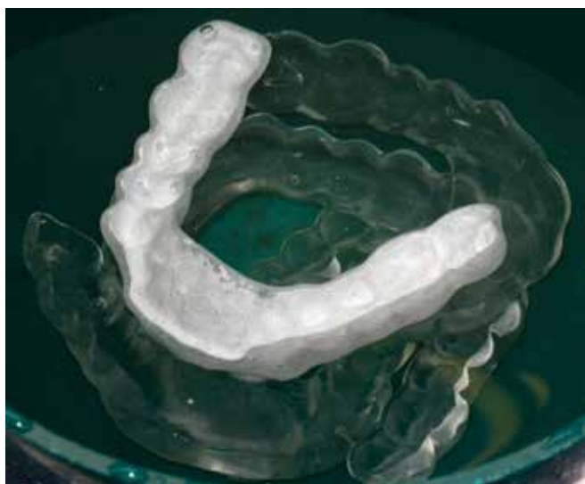
Kaikki PalaXpress kylmäakryyliset purentakiskot vesiku-pissa testauksen jälkeen. Kontrasti kiskojen välillä suuri.
