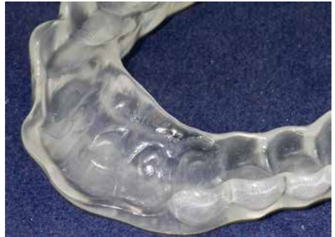
A) Purentakisko ollut yhteensä 16 tuntia 100% väkiviinaetikassa.
