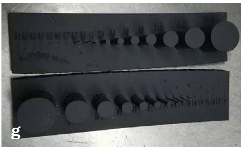
Kuva 6. Yleisimmät ongelmat olivat tulosteiden taipuminen, osittainen tulostumattomuus ja muodon epätarkkuus.
