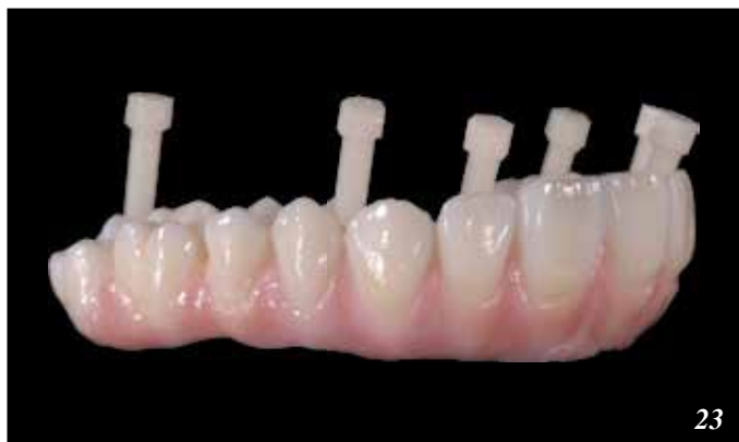
Ruuvikanavatulpat Screw Blank resiniistä. Ne voidaan ruuvata suoraan ruuvikanavien peitoksi ja poistaa tarvittaessa ulosvetäjä työkalulla. (kuva 23.)
