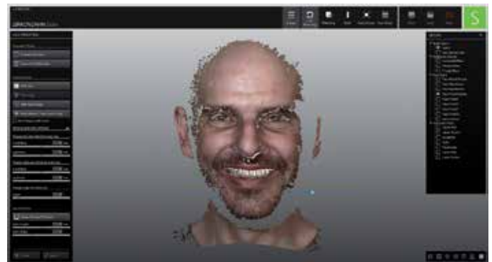
9a ja 9b - Potilaan kasvojen digitalisointi prototyyppien kanssa
