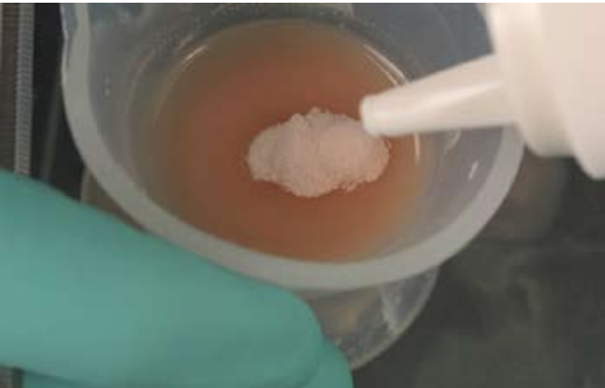
Kuva 9. Lisää polymeerijauhetta aiemmin sekoitettuun löysään kyl- mäakryliseokseen.
