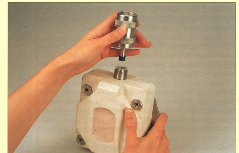
Kuva 5. Jälkiprässäyskoje pitää paineen polymeroinnin ajan.
