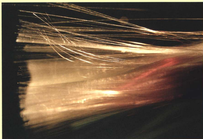
Kuva 1. Yksisuuntaisia lasikuituja, joita käytetään muovien lujittamisessa. Edellytyksenä muovin lujittumiselle on, että muovi on tunkeutunut kaikkien kuitujen ympärille. Tämä voidaan saada aikaan kuitujen ns. esi-impregnoimisella.
