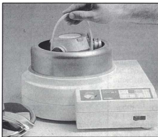
Kuva 8. Painekattila voidaan avata kesken polymerisaatioajan.
