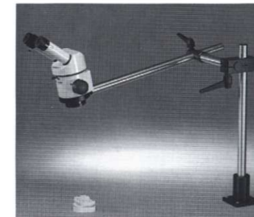
WILD M 3 B erikoismalli hammaslaboratorioihin - suurennukset 3.2x, 8x ja 20x
