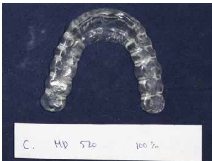
C. Purentakisko ollut yhteensä 16 tuntia 100% MD 520:ssa. Ei havaittavia muutoksia.
