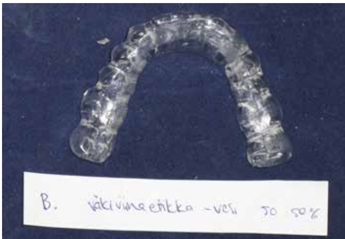
B. Purentakisko ollut yhteensä 16 tuntia 50% väkiviinaetikka - 50% vesi -liuoksessa. Ei havaittavia muutoksia.
