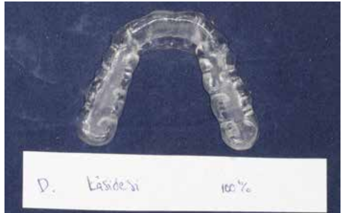
D. Purentakisko ollut yhteensä 16 tuntia 100% käsidesissä. Havaittu jo paljaalla silmällä materiaalin samentumista.
