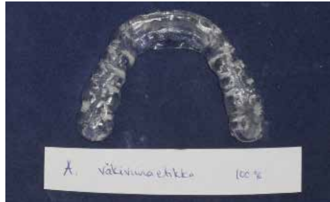
A. Purentakisko ollut yhteensä 16 tuntia 100%:ssa väkiviinaetikassa. Ei havaittavia muutoksia.
