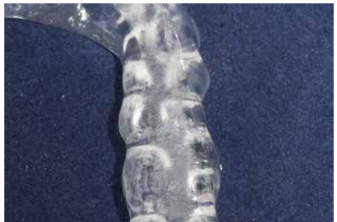
D. Lähikuva purentakiskosta, joka kärsi suurimmat vahin- got ja sen samentuneesta pinnasta. Kisko ollut 16 tuntia 100%:ssa käsidesissä.
