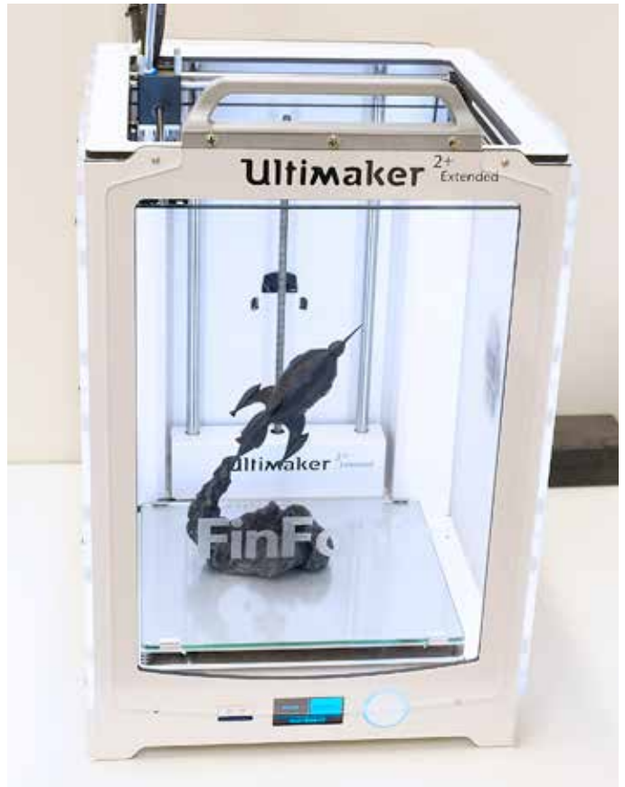
FDM-printteri tulostaa muoveja, komposiittia, nylonia, puu- ja metallijäljitelmiä.
