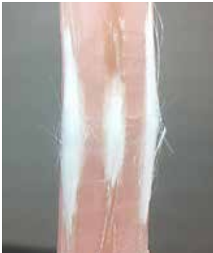
Kuvio 9. everStick-kuiduilla vahvistettu koekappale kolmepistetaivutuksen jälkeen.
