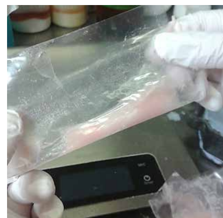
Kuvio 5. Perinteisen Stick-kuidun kyl- lästämistä neste-jauheakryyliseoksella muovikalvon sisällä.
