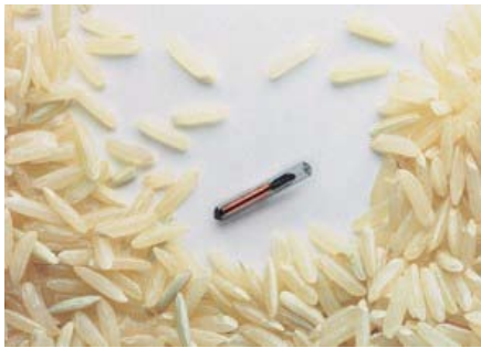
KUVA 8 Data Mars -biolasin sisällä oleva mikrosiru: vertauskohtana riisinjyviä (Kuva: www.datamars.com ).
