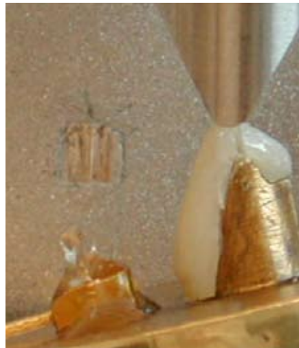
Kuva 4. Kuituvahvistettu laminaatti puristuslujuustestissä jossa akustisen emissio mikrofoni kerää tietoa murtuman muodostumisen alkuhetkestä.
