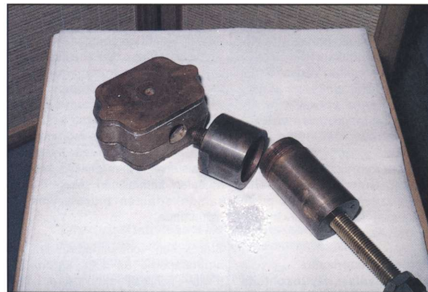
Kuva 2. Vasemmalla kyvetti, keskellä syöttökartio ja oikealla sylinteli ja ruuvipuristin.
