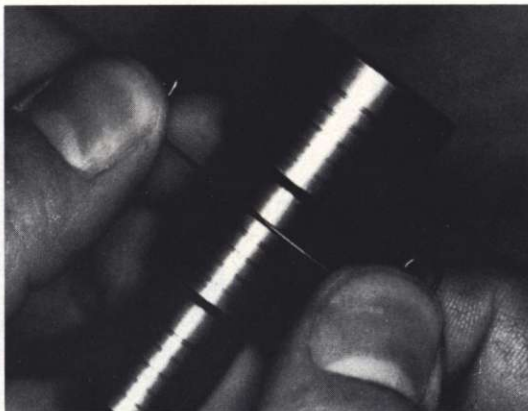
Kuva 8. Varsinaisen kaaren taivutus suoritetaan pyöreällä langantaivutustuella.
